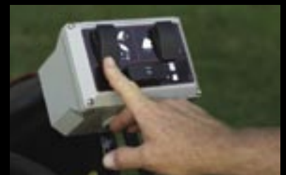
ワークマン作業車の運転席に取り付ける標準コントロール・ボックス。
